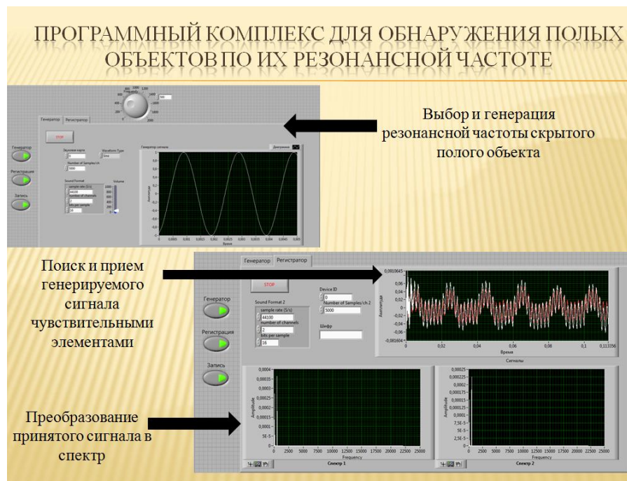
Рис. 4 Внешний вид лицевой панели программы «Программный комплекс для обнаружения полых объектов по их резонансной частоте»
