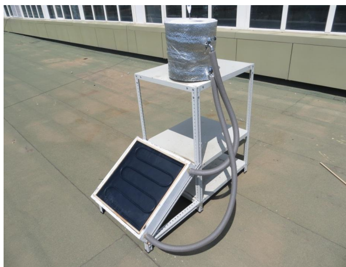
Рис. 4. Экспериментальная СВУ термосифонного со змеевиковым абсорбером ЛНЭ СНЦ РАН при АГТУ
