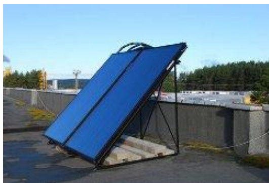
Рис. 1. Селективные плоские КСЭ с двухслойным слойным остеклением СПК-2
