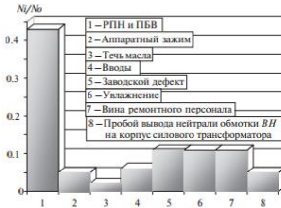
Рис. 1. График отказов элементов силового трансформатора.
